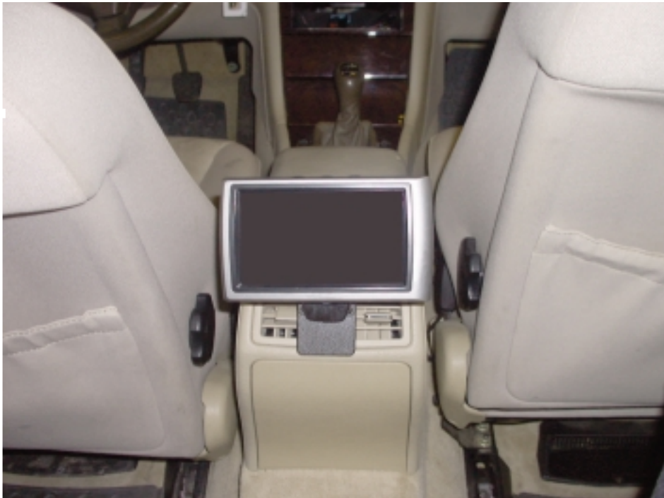
Baksetemontering mellom framsetene. LCD-skjerm på plass.
